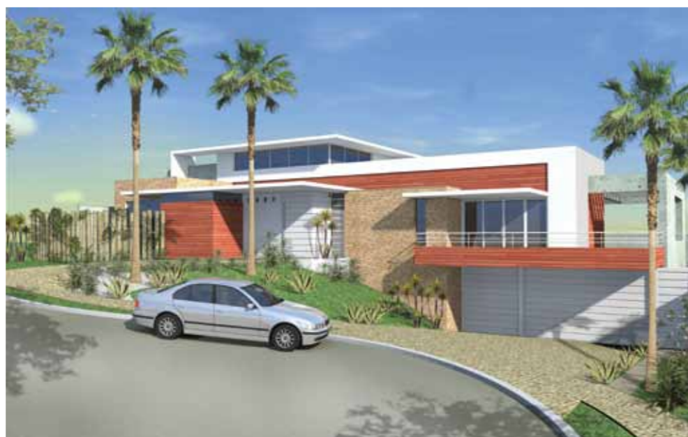
Projeto de uma residência térrea em dois lotes do condomínio St. Gerard. Os ambientes se desenvolvem em um único nível, a área de lazer em nível mais baixo e garagem no subsolo aproveitando a topografia do terreno. A planta em formato de "L" se abre para uma bela vista de todo o condomínio e a cidade ao fundo. Predominância da pintura branca com alguns toques de materiais rústicos como a madeira na entrada social e volume da sala de estar, mosaico português no volume da escada e toras de eucalipto tratado fazendo o fechamento da brinquedoteca no lado esquerdo da casa. Grandes aberturas em vidro trazem iluminação natural para a sala de estar e proporcional leveza à obra.
